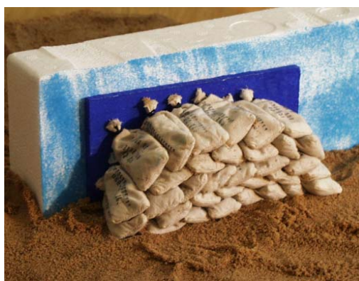
Obr. 25 Příložné těsnění s deskou
