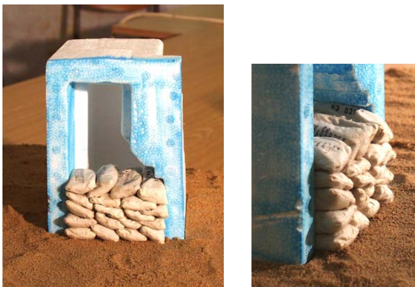
Obr. 21 a 22 Částečné utěsnění dveří
