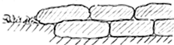
Obr. 15 Vázání hráze do terénu
